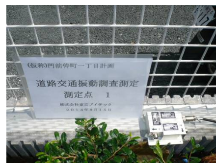
地盤上振動測定
