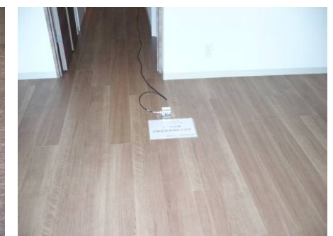
12階住戸振動測定
