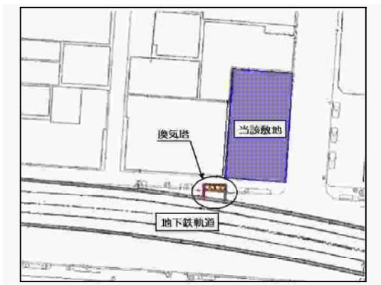
図1 地下鉄と建物との関係 (平面図)
